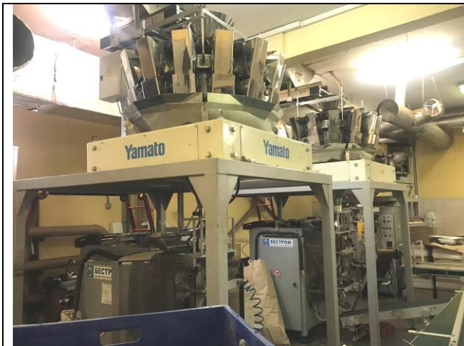
Упаковочный автомат универсальный "Бестром-202М" с комбинационным весовым дозатором Ямато ADW-514
