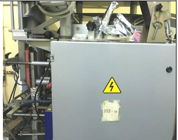
Упаковочный автомат универсальный "Бестром-202М" с комбинационным весовым дозатором Ямато ADW-514
