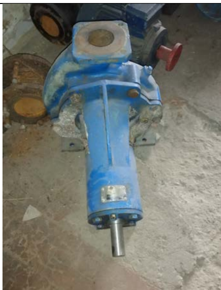
ФОТО № 9. Насос консольный К 100-65-250 45 квт, инв. № 000000148
