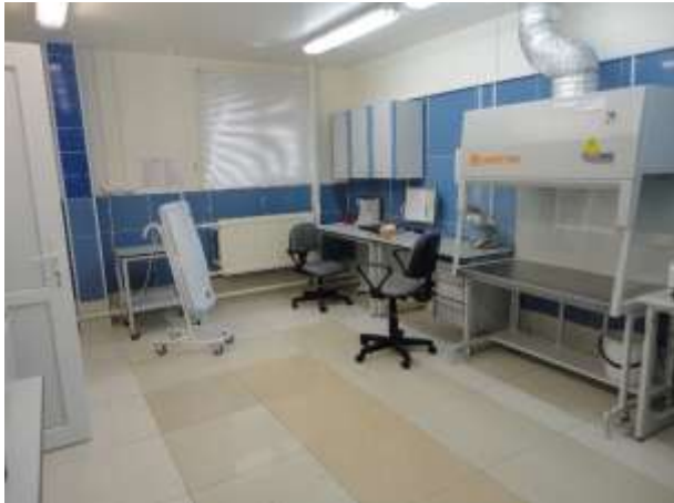
26. Шкаф вытяжной ЛАБ-PRO-ШВЛВЖ-150 КЕРАМИКА.
