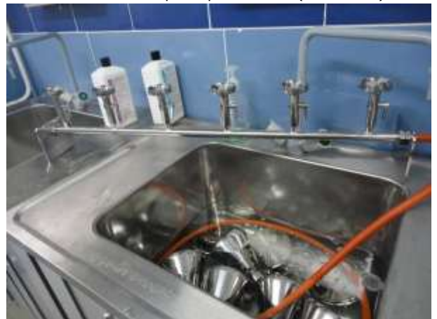
12. Установка фильтрационная (6×500 мл).
