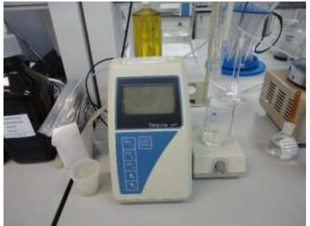
29. Титратор TITROLINE EASY MODULE 2.
