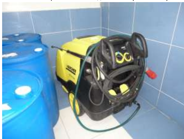
127. Аппарат высокого давления (KARCHER).
