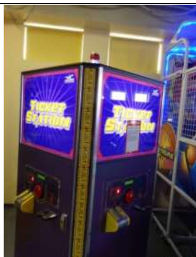
Автоматический счётчик билетиков
